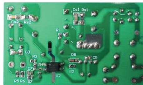
Рис. 7. Внешний вид платы драйвера со стороны печатных проводников
