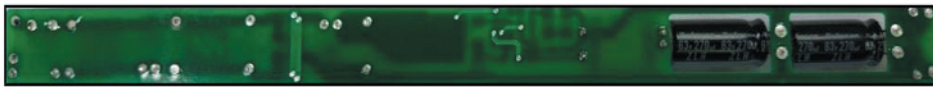
Рис. 6. Внешний вид платы драйвера T8/18W 12S 425 mA AC-DC LED Tube со стороны печатных проводников
