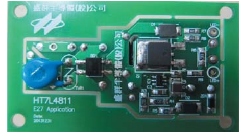
Рис. 10. Внешний вид платы драйвера E27/8W 13S 162 mA AC-DC LED Bulb со стороны установки мелких деталей
