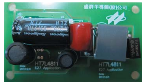
Рис. 11. Внешний вид платы драйвера E27/8W 13S 162 mA AC-DC LED Bulb со стороны установки крупных деталей
