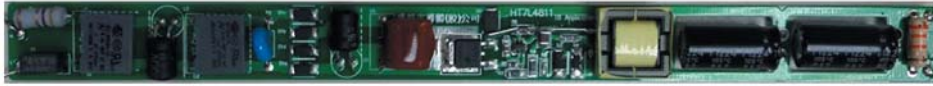
Рис. 5. Внешний вид платы драйвера T8/18W 12S 425 mA AC-DC LED Tube со стороны деталей
